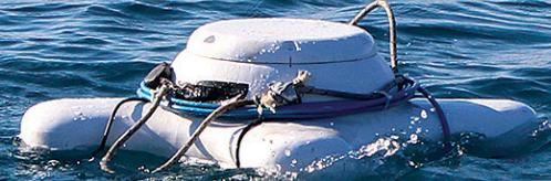
Autonomna površinska platforma komunicira s roniocem i autonomnim podvodnim robotom te služi kao komunikacijska veza s komandnim centrom, ali ima i ključnu ulogu u navigaciji autonomne ronilice
