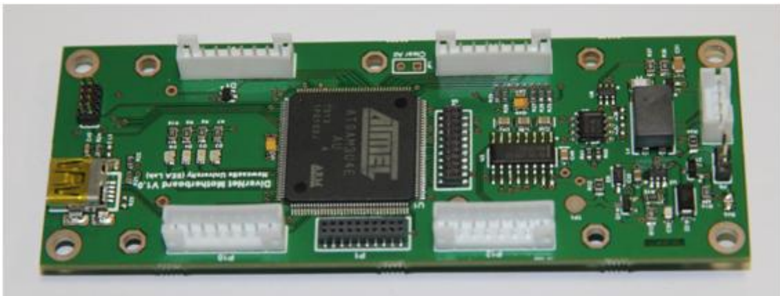
Fig. 3.2. DiverNet 'Hub' PCB : Dimensions 107mm x 40mm
